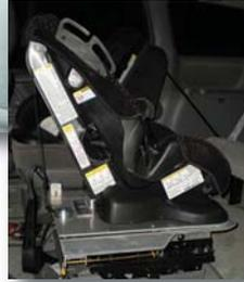
l'un des sièges à l'arrière du véhicule dont nous avons gardé la base d'attache au plancher et sur lequel nous avons fixé un dispositif pivotant. Le dispositif permet de tourner le siège d'enfant de côté tout en le rapprochant vers la sortie afin de prendre l'enfant (photo en haut à gauche) et de fixer le siège face à l'arrière pour les déplacements (photo adjacente).
